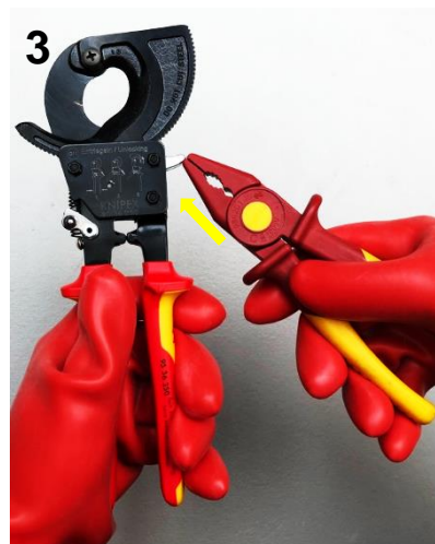
Bei geschlossen gehaltenen Griffen die Haltekinke (2) mit der isolierten, isolierenden oder Hybridzange nach oben drücken
