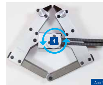
Abb. 5 Vorbereitung des Werkzeuges: Werkzeug durch Drehen des Einstellrades 4 in geschlossene Position bringen
