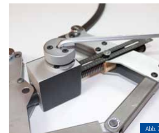
Abb. 7 und Abb. 8 Lösen des Sicherungsringes: Mit beigelegtem gebogenen Innensechskantschlüssel 5 bzw. mit dem in eine passende Maschine eingesetztem sechskant – Bit 6 mm (für maschinelle Verstellung) 6 in der Öffnung des Einstellrades 4 Werkzeug soweit öffnen, dass der Sicherungsring von der Welle oder aus dem Zylinder entnommen werden kann
