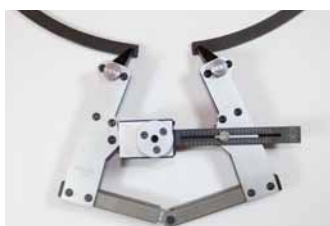
Abb. 9 Gelöster und frei liegender Sicherungsring
