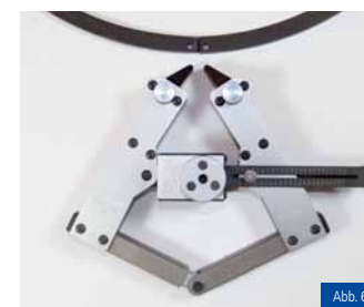
Abb. 6 Positionieren und Einsetzen: vorbereitetes Werkzeug in Position zum Sicherungsring bringen und Werkzeug in die Bohrungen des Sicherungsringes einsetzen
