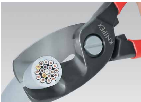
Vorschnitt: Durch Einsatz der vorderen Schneide zum Schneiden des Isoliermantels bei größeren Kabeldurchmessern bleibt eine ergonomische Griffweite erhalten.
