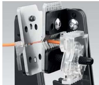
Automatisches Abziehen der Isolation
