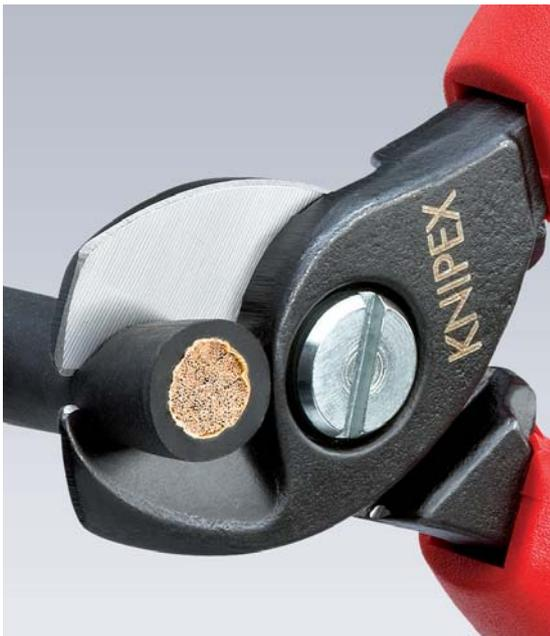
Kabelschnitt mit Kabelschneider:
