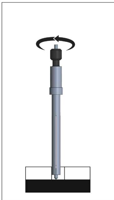
1. Insérer le pointeau de centrage de taille appropriée dans le trou, tourner la vis moletée
