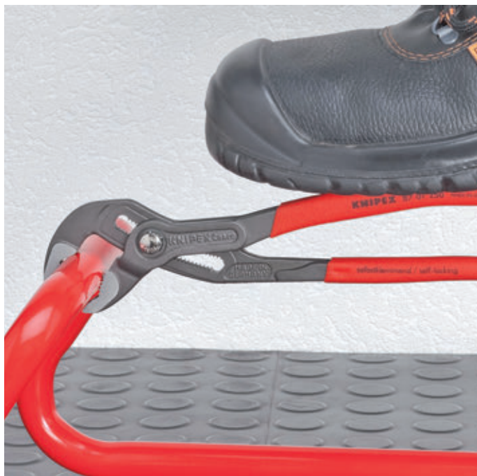
Gegen die Drehrichtung versetzte Zähne bewirken einen Selbstklemmeffekt und verhindern das Abrutschen am Werkstück.
