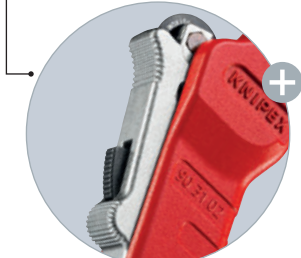
Durch die Einhandschnellverstellung kann das abgedeferte Schneidrad an den Durchmesser des Rohres herangeschoben und fixiert werden
