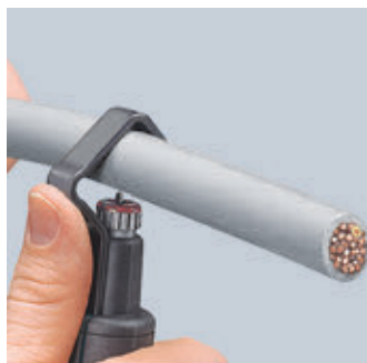
Ansetzen des Werkzeugs für Umfangsschnitt
