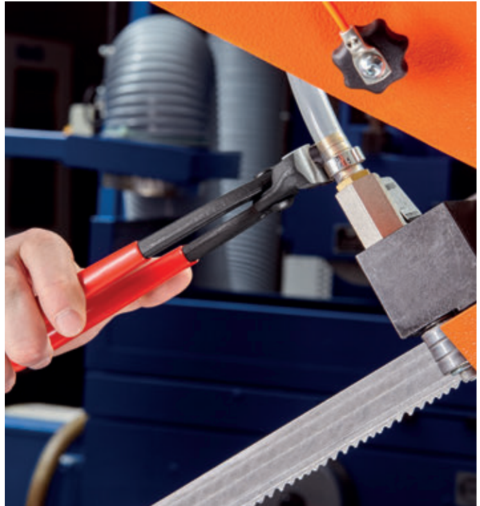
Abdichten Fluidschlauch an Stutzen mittels Seiten-Pressnase
