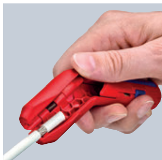
Abmanteln eines Koaxialkabels
