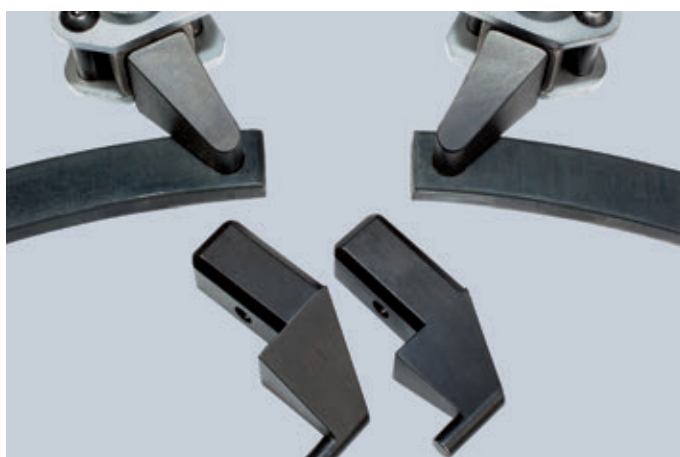
Wechselbare Einsätze für Innen und Außenringe
