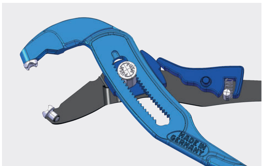
Der Feststeller der Federbandschellenzange ermöglicht einfaches und sicheres Arbeiten auch bei gespannter Schelle. Moderne CAD-Technik simuliert den Mechanismus am Bildschirm.
