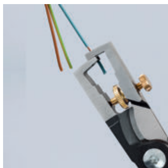
Längenmarkierung: Profilierung der Innenseite unterstützt beim wiederholten Abisolieren gängiger Längen (11 mm und 16 mm)
