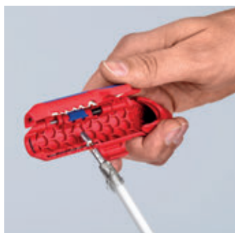
Abisolieren eines Koaxialkabels
