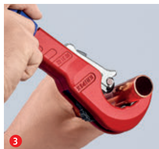
Durch Drehung schneiden und dabei mit dem ergonomischen blauen Drehknäuf nachstellen ...
