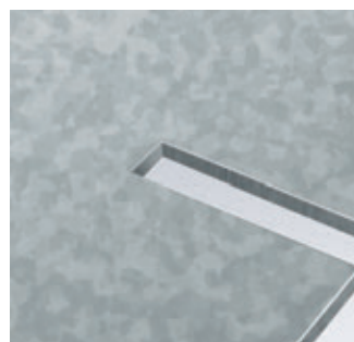
Ausklinken und Spanbrechen in einem Arbeitsgang
