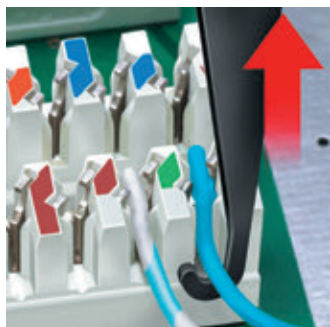
Mit integriertem Ziehaken
