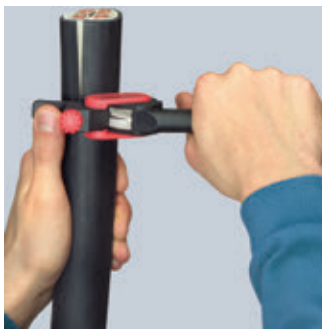
Drehen des Werkzeugs für Umfangsschnitt
