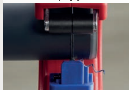
Det går att kapa korta segment på bara 10 mm. Spiralspänen kommer från avfasning.
