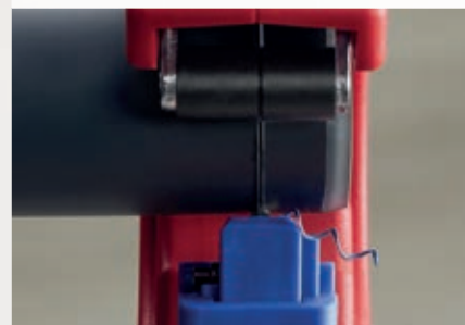
Oppdelinger ned til 10 mm kan kuttes. Spiralbrikken kommer fra avfasing.
