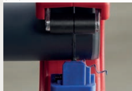
Si possono impostare anche intervalli di soli 10 mm. Il truciolo si forma durante la svasatura.
