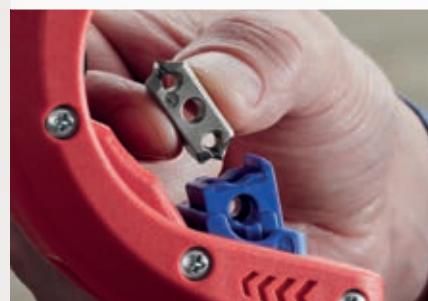
In caso di usura la lama può essere girata o sostituita senza utensili.
