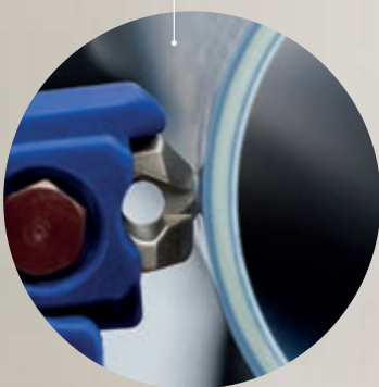
Einmal angesetzt, übt die abgefederte Schneidklinge genügend Druck für den Schnitt aus – kein Nachstellen nötig!
