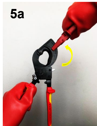
Bei geschlossen gehaltenen Griffen die Halteklinke (2) mit der isolierten, isolierenden oder Hybridzange nach oben drücken
