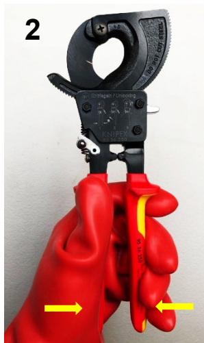
Griffe des Kabelschneiders schließen
