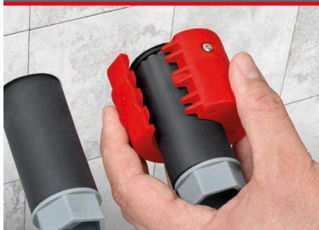
Den unike designen til den roterende bladenheten betyr at drypp- og tetningshylser kan kuttes 2 til 3 mm fra veggen så fuktighet renner vekk på en sikker måte
