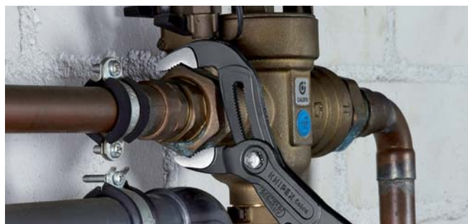
Los dientes desplazados con respecto al sentido de giro provocan un efecto de auto-retención y evitan el deslizamiento sobre la pieza.
