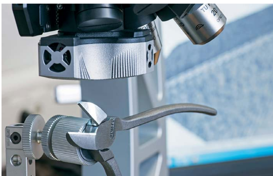
En los alicates de corte diagonal se mide con precisión la forma y la rugosidad de la cuchilla con el sistema óptico de medición 3D.
