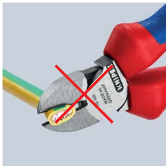
Efecto de corte con un alicate de corte diagonal: requiere un gran esfuerzo, corte inadecuado, deformación considerable del cable
