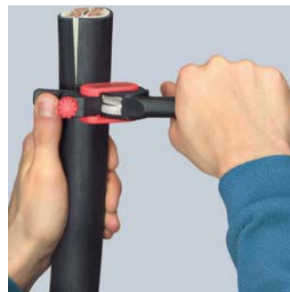
Girar la herramienta para el corte perimetral
