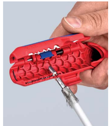
Pelar un cable coaxial
