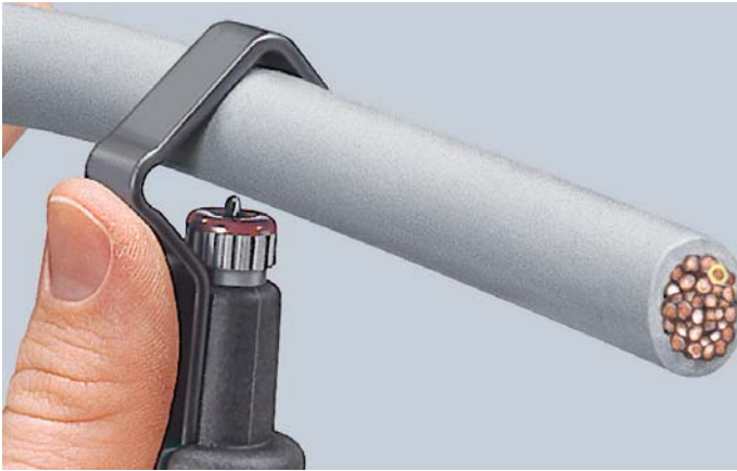
Colocar la herramienta para corte circular
