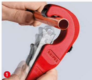
1 Couper simplement : placez le KNIPEX TubiX® ouvert ...
