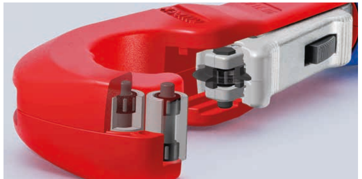
Des roulements à aiguilles de haute qualité permettent à la molette de coupe et aux quatre rouleaux de guidage de fonctionner pratiquement sans frottement gênant pendant la coupe – coupe les tubes en acier inoxydable avec une facilité extraordinaire
