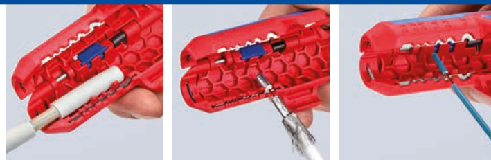
Dégainage d'un câble NYM
