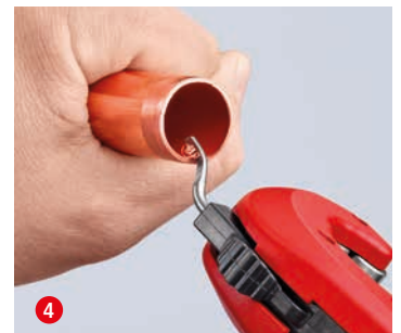
4 Et voilà ! Au besoin, lissez l'arête de coupe avec l'outil d'ébavurage escamotable, avec étonnamment peu d'effort
