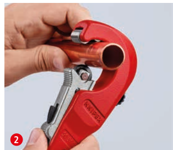
2 Poussez la molette de coupe contre le tube avec le système QuickLock à verrouillage en butée rapide d'une seule main : le réglage le plus rapide pour différents diamètres de tubes ...
