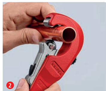
Schneidrad mit QuickLock-Einhandschnellfixierung ans Rohr schieben: schnelle Einstellung an unterschiedliche Rohrdurchmesser ...
