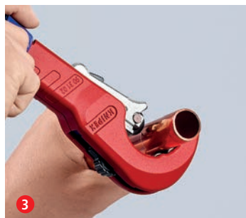
Durch Drehung schneiden und dabei mit dem ergonomischen blauen Drehknäuf nachstellen ...
