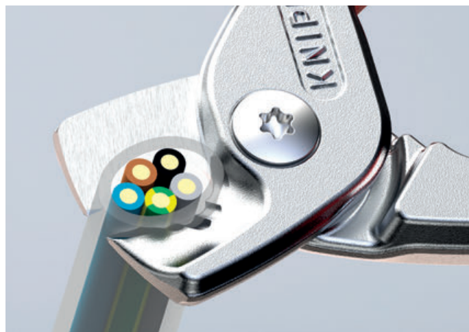
Corta cables sólidos de Cu y Al hasta 5 x 4 mm 2
