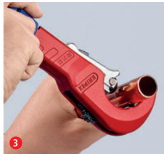
3 Corte con un giro rápido y luego reajuste la profundidad usando la rueda ergonómica azul ...
