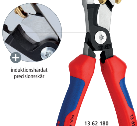
Induktivt härdat precisionsskär för klämfri klippning av koppar- och aluminiumkabel upp till Ø 15 mm (5 x 2,5 mm 2 )
