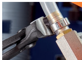
10 98 I220: Tätning slanganslutning mot centralsmörjningen
