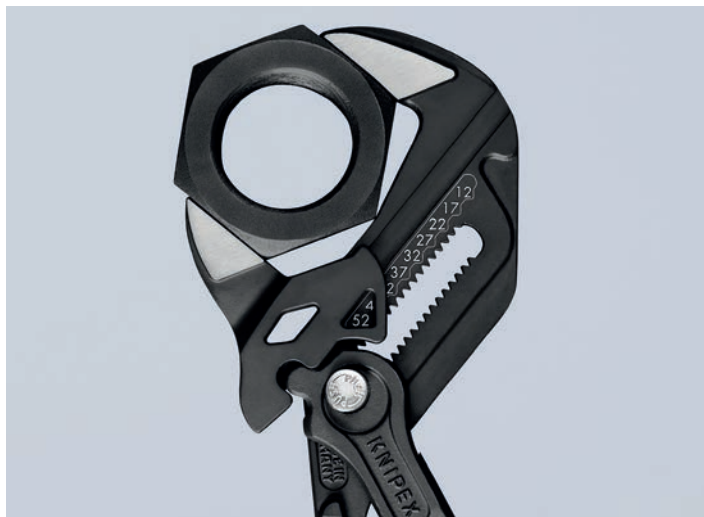
Nyckelstorlek laseretsad på tånghuvudet: mm på framsidan och tum på baksidan
