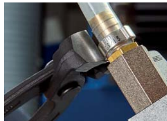
10 98 I220: Tætning fluidslange til studs via side-presenæse
