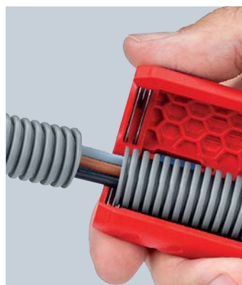
Pæn skærekant og ingen beskadigelse af de indvendigt liggende kabler, da snittet altid foretages oppe på bølgen
