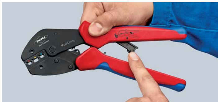
De positioneringspal inklappen en de tang doordrukken – klaar voor de volgende toepassing
