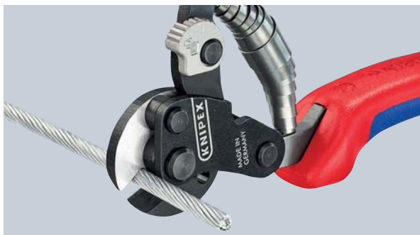
Knippen van zeer stevige draadkabels (1960 N/mm 2 ) tot Ø 4 mm
