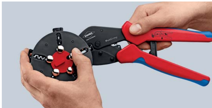
Krimprofiel vervangen: magazijn ontgrendelen, krimpprofiel uit de tang nemen
