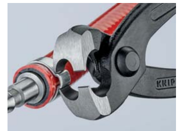
10 99 I220: Afdichten vloeistofslang bij steunpunten met zijdelingse persbek
