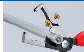
Inductief gerhard schaarlemmet, precisiegeslepen, voor het knelvrij snijden van koperkabels tot Ø 15 mm (5 x 2,5 mm 2 )
