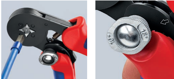
Skifting av presskapasiteten fra 10 mm 2 til 16 mm 2 utføres med enkel omkopling
