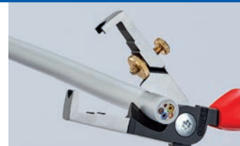
Induktivt herdet saksskjær med presisjonsslip for klemfri klipping av kobber- og aluminiumkabler inntil Ø 15 mm (5 x 2,5 mm 2 )
