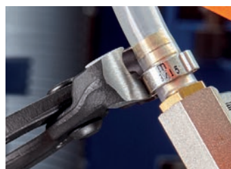
10 98 1220: Tetting slange-tilkopling til sentralsmøring
