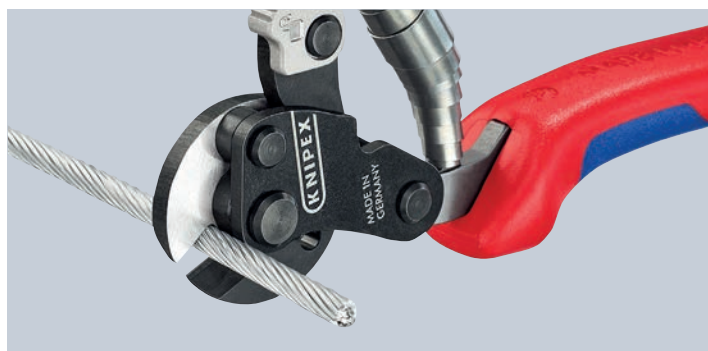
Kutting av høfaste wirer (1960 N/mm 2 ) inntil Ø 4 mm
