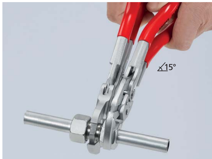
86 43 250: Ручки инструмента под углом 15° – для лучшего доступа к детали при контрениии или заворачивании близко к основанию; меньше риск травмировать пальцы
