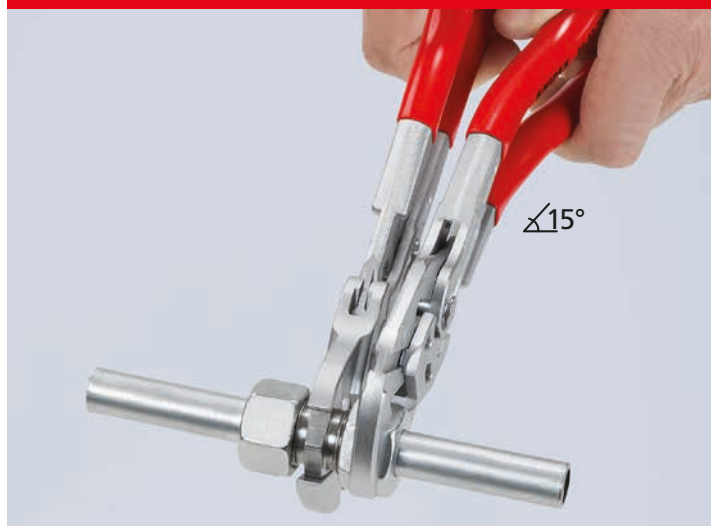
86 43 250: 15° vinklede kjeft for klaring ved kontra- eller forskruinger på flater: Mindre fare for håndleddskader
