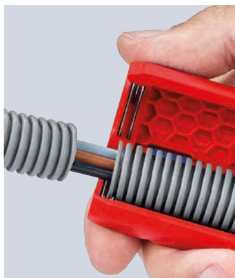
Rent kantsnitt og ingen skader på indre kabler, fordi snittet alltid skjer oppe på akselen
