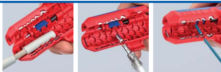
Odizolování kabelu NYM
