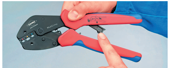
De positioneringspal inklappen en de tang doordrukken - klaar voor de volgende toepassing
