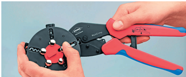
Krimpprofiel vervangen: magazijn ontgrendelen, krimpprofiel uit de tang nemen
