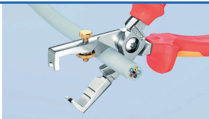
Inductief gehard scharlemmet, precisiegeslepen, voor het knelvrij snijden van koperkabels tot Ø 15 mm (5 x 2,5 mm 2 )
