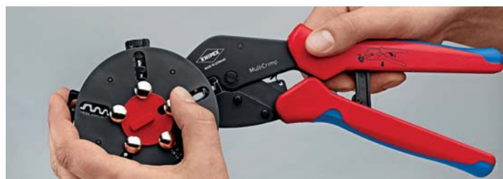
Cambio de la mordaza de entallaje: desbloquear la posición del almacén, extraer la mordaza de entallaje del alicate
