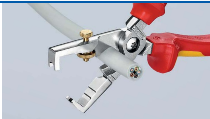
Filo de corte con rectificación de precisión, templado por inducción para un corte sin aplastamiento de cables de cobre de hasta Ø 15 mm (5 x 2,5 mm 2 )
