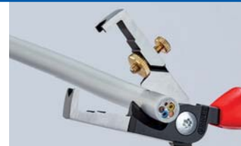
Lâmina para corte temperada de forma indutiva, com gume de precisão, para corte sem esmagamento de cabos de cobre até Ø 15 mm (5 x 2,5 mm 2 )
