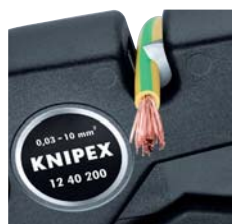
Cortador de fio até 10 mm 2 de fios múltiplos
