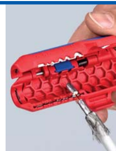
Retirada do isolamento de um cabo coaxial
