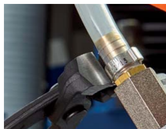
10 98 I220: Герметичное крепление хомутом шланга на штуцере системы централизованной смазки
