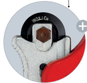
Das nadelgelagerte und abgefederte Schneidrad aus hochwertigem Kugellagerstahl ist leicht wechselbar
