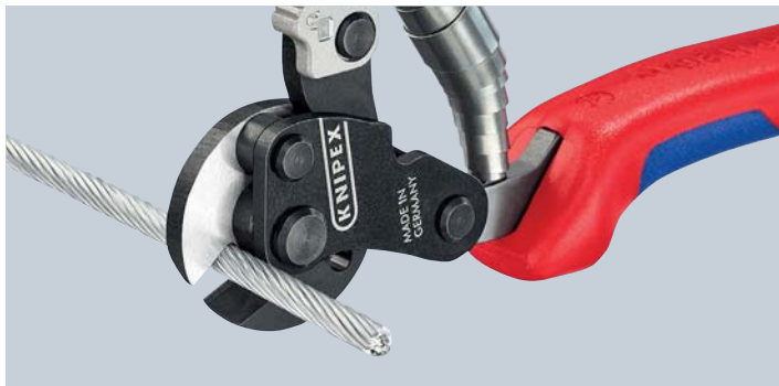
Schneiden von hochfesten Drahtseilen (1960 N/mm 2 ) bis 4 mm \varnothing
