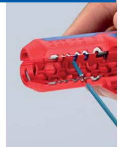
Abisolieren von Einzelleitern
