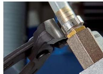
10 98 I220: Abdichten Schlauchanschluss an Zentralschmierung
