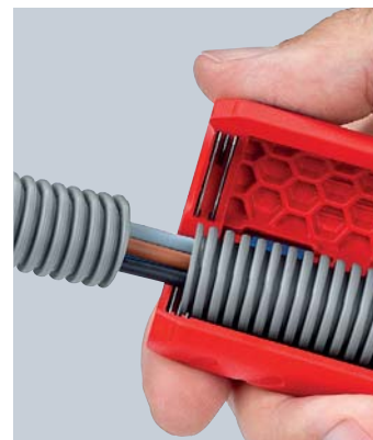
Saubere Schnittkante und keine Beschädigung der innen liegenden Kabel, da der Schnitt immer oben auf der Welle erfolgt
