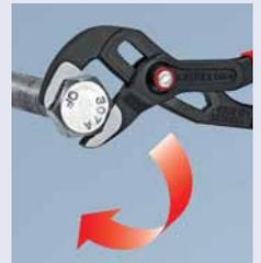
Gelenkbolzen rastet bei Belastung ein
