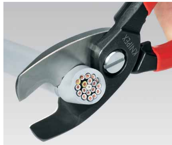
Nachschnitt: Nachdem der Mantel des Kabels im vorderen Profil durchgeschnitten wurde, werden die Leiter im hinteren Profil durchtrennt. Vorschnitt vorn, Nachschnitt hinten – so schneidet es sich leichter
