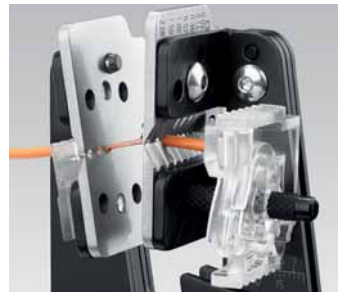
Automatisches Abziehen der Isolation
