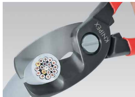
Vorschnitt: Durch Einsatz der vorderen Schneide zum Schneiden des Isoliermantels bei größeren Kabeldurchmessern bleibt eine ergonomische Griffweite erhalten.
